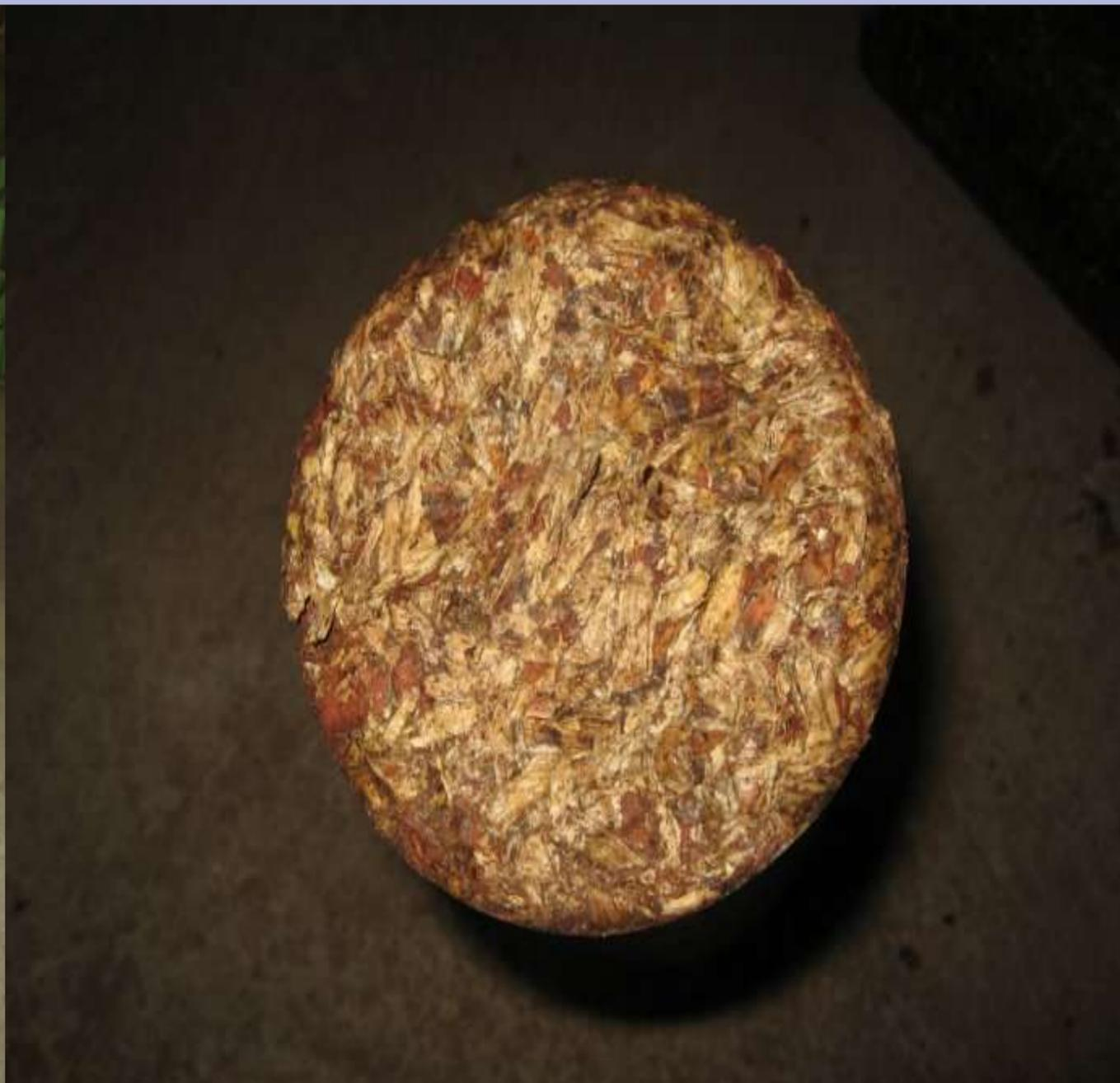
No ano de 2013 a Brasil Biomassa desenvolveu uma série de estudos e um protótipo industrial do biobriquete de bagaço e palha da cana-de-açúcar para a instalação de uma grande unidade industrial no Nordeste do Brasil.
