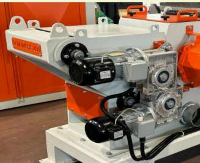
**TRITURAÇÃO DE MATÉRIA-PRIMA.** No primeiro estágio, a biomassa deve ser triturada para obter tamanhos de partículas menores que 50 mm (furos de peneira de  $\varnothing = 15$  mm). O triturador de matéria-prima é uma máquina de construção mecânica sólida, adequada para transformar qualquer tipo de matéria-prima em resíduos de baixa granulometria. Graças ao seu sistema de trituração fornece um produto de saída homogêneo e uniforme.
