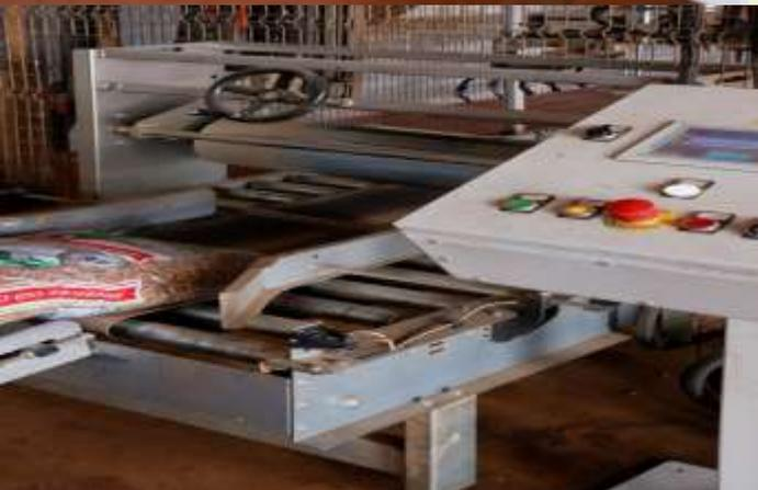
**PAINEL DE COMANDO.** Quadro de Comando em baixa tensão e grau de proteção IP 54 montado com as seguintes características técnicas: Trifásico + N/T 380 Volts 60 Hz. Armário auto portante para instalação abrigada, estrutura monobloco em chapas de aço bitola 14, com pintura eletrostática em pó poliéster cinza RAL 7032, e placa de montagem.
