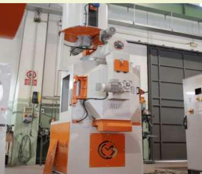
**MOINHO MARTELOS.** Uma grade de calibração durável e facilmente intercambiável, colocada a uma distância específica dos martelos, permite a redução do material no volume necessário. A máquina também é equipada com uma matriz dupla cada um com oito arestas de corte usadas sequencialmente com base em seu desgaste. Em ambos os lados das máquinas, há duas portas de inspeção largas, projetadas para facilitar as operações de manutenção.
