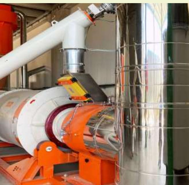
**SECADOR DE TAMBOR ROTATIVO.** O sistema de secagem também inclui um termorregulador resistente ao calor, anemômetro e sonda de fio para medições contínuas de perdas de água. Os secadores de tambor rotativo de passagem simples ou tripla são caracterizados pela continuidade, confiabilidade e eficiência operacional de longo prazo no tratamento de diferentes tipos de materiais, com alta umidade de entrada.
