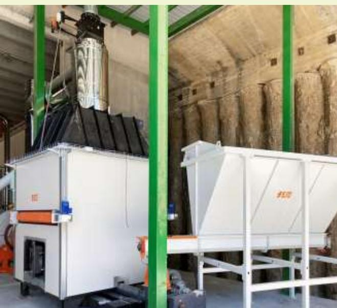
**TREMONHA ENTRADA E SAÍDA DE MATÉRIA-PRIMA.** Instalada no nível inicial do projeto industrial para poder receber a matéria-prima de forma manual ou automática, com a função de armazenar a matéria-prima para dosagem no sistema industrial de secagem. Um rolo horizontal equipado com arpões e dois rolos inferiores permitem o transporte do produto de entrada para a câmara de corte. A grade de calibração permite definir a dimensão do material de saída.
