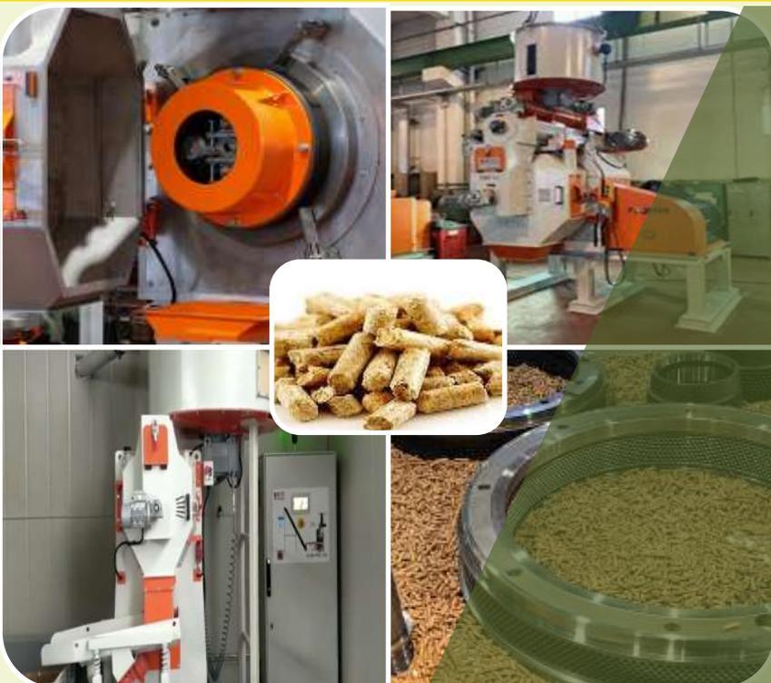
**TECNOLOGIA INDUSTRIAL 4.0 DE PELETIZAÇÃO.** O material seco e refinado é transportado para o silo de abastecimento ao processo de peletização industrial. A peletização permite a produção de um produto homogêneo em relação à forma, tamanho e consistência. O produto final, caracterizado por maior densidade e valor de aquecimento por unidade de volume, é adequado para embalagem, armazenamento, transporte e usabilidade.
