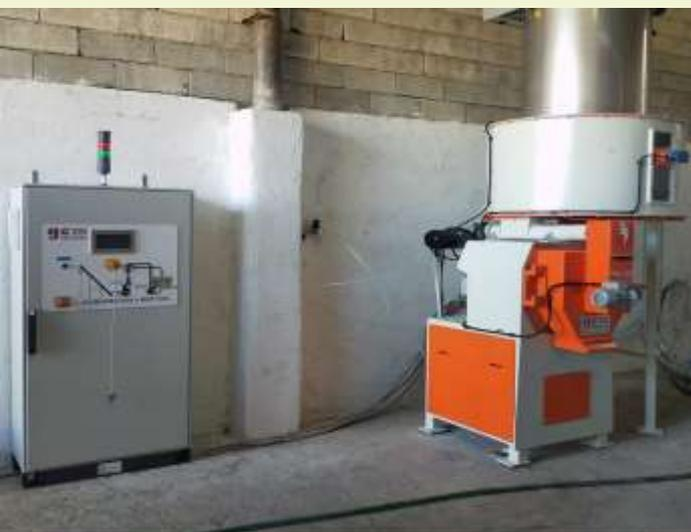
**PAINEL DE ENERGIA.** Instrumentação, esta previsto a instalação de: Multimetro com funções de amperímetro e voltímetro. Chave Geral de bloqueio. Potenciômetro para acionamento do inversor de frequência da Rosca Alimentadora e do Condicionador. Botoeiras Industriais Liga/Desliga para comando dos motores envolvidos na operação Confeccionados em barras de cobre eletrolítico, dimensionados para suportar a corrente de projeto.
