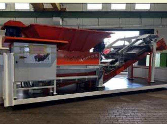
**TRANSPORTE DA MATÉRIA-PRIMA.** A dosagem de carga e a descarga da matéria-prima podem ocorrer por meio de diferentes sistemas de transporte (mesa vibratória, rolo, ventilador). O material triturado é depositado na tremonha de matéria-prima e transportado (transporte pneumático) para o sistema de geração de energia térmica (fornalha industrial) ao sistema de secagem industrial.
