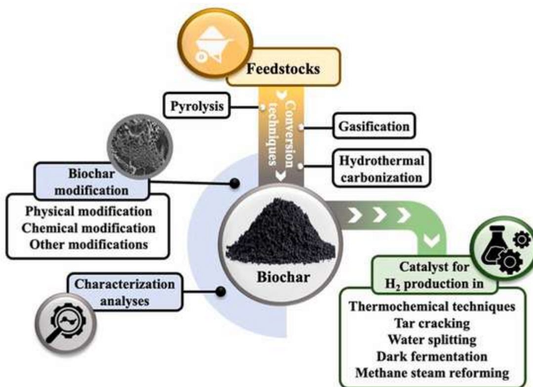
Figura 12. Rotas de produção e modificação de biochar para aplicação de catalisador em hidrogênio. Reproduzido com permissão de [ 14 ].
